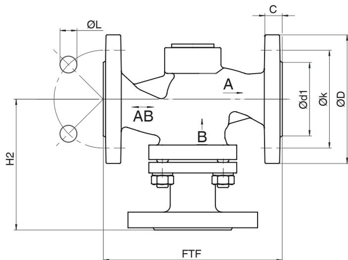
Type de raccordement bride, encombrement EN 558 (code 39)<sup>1)</sup>, inox de fonderie (code 37)<sup>2)</sup>
