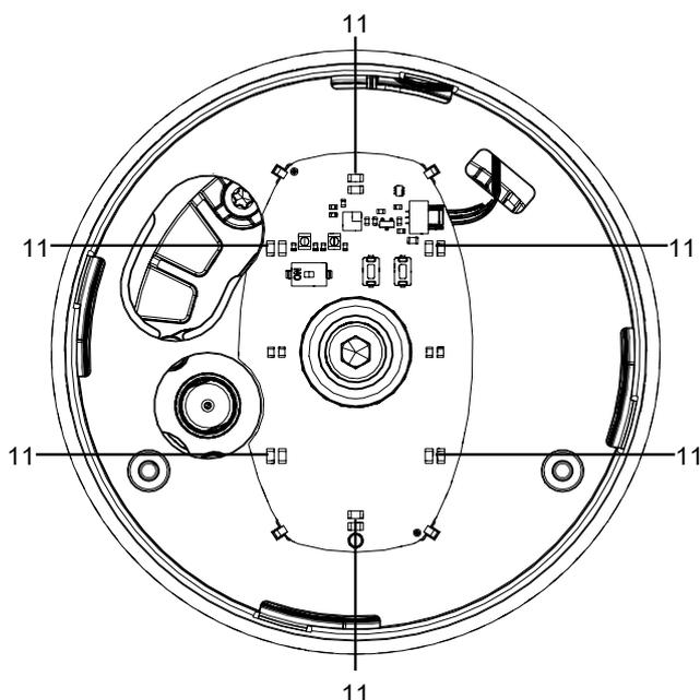
Fig. 3: Position des LED visibles de loin
