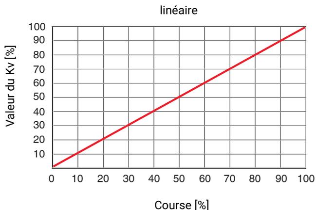
Le diagramme restitue le cours approximatif de la courbe Kv. La courbe peut en diverger en fonction du corps de vanne, du diamètre nominal, du clapet et de la course de la vanne.
