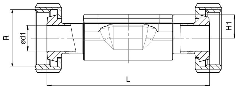
**Type de raccordement embout conique DIN (code 6K)<sup>1)</sup>, inox forgé (code 40, 42)<sup>2)</sup>**
