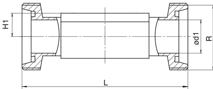
**Type de raccordement embout fileté DIN (code 6)<sup>1)</sup>, inox forgé (code 40, 42)<sup>2)</sup>**
