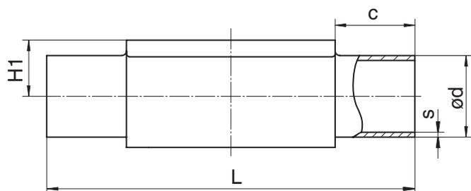
Type de raccordement embout DIN/EN/ISO (code 17, 60)<sup>1)</sup>, inox de fonderie (code C3)<sup>2)</sup>
