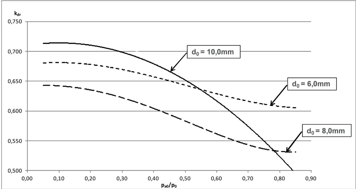
$$\frac{p_{a0}}{p_0} = \frac{\text{Contre-pression bar(a)}}{\text{Pression de décharge bar(a)}} \quad p_{atm} = \text{pression ambiante ou pression atmosphérique} = 1,01325 \text{ bar(a)}$$
